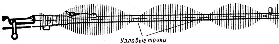
Схематическое изображение вибрации ствола при выстреле
